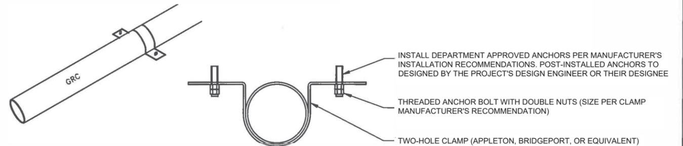
**C. TYPICAL GALVANIZED RIGID CONDUIT (GRC)
