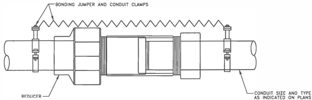
**A. TYPICAL EXPANSION COUPLING DETAIL**
