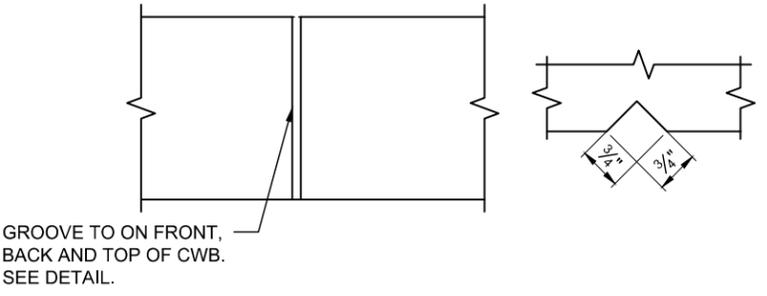
**CRACK CONTROL JOINT DETAIL**
