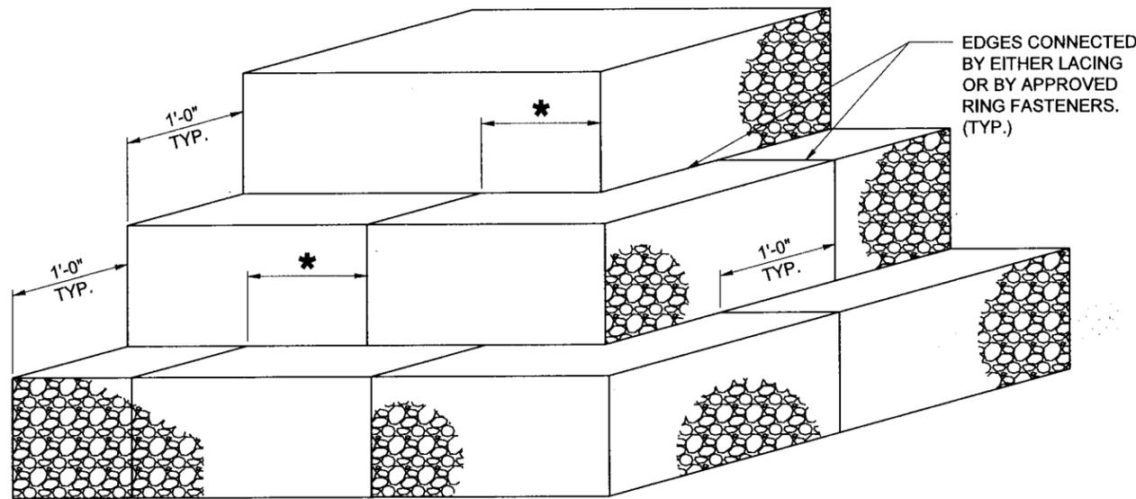
TYPICAL VIEW OF GABION RETAINING WALL
