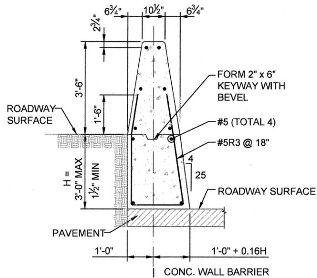
**TYPICAL SECTION FOR VERTICAL ROADWAY OFFSETS**
