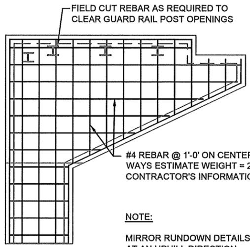
REBAR PLACING PLAN
