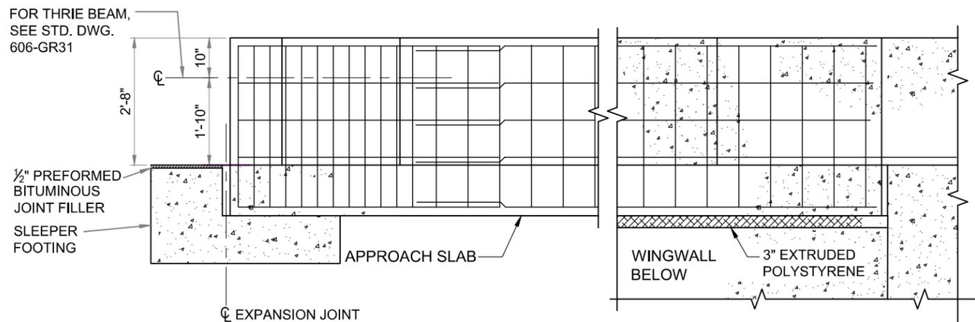
ELEVATION AT TRANSITION TO GUARDRAIL
