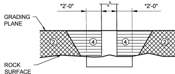
BACKFILL IN SECTION B-B: IN ROCK
