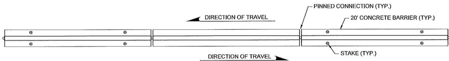
**STAKING CONFIGURATION FOR TWO-WAY TRAFFIC**
