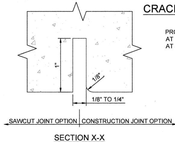
**CRACK CONTROL AND CONTRACTION JOINT DETAILS**
